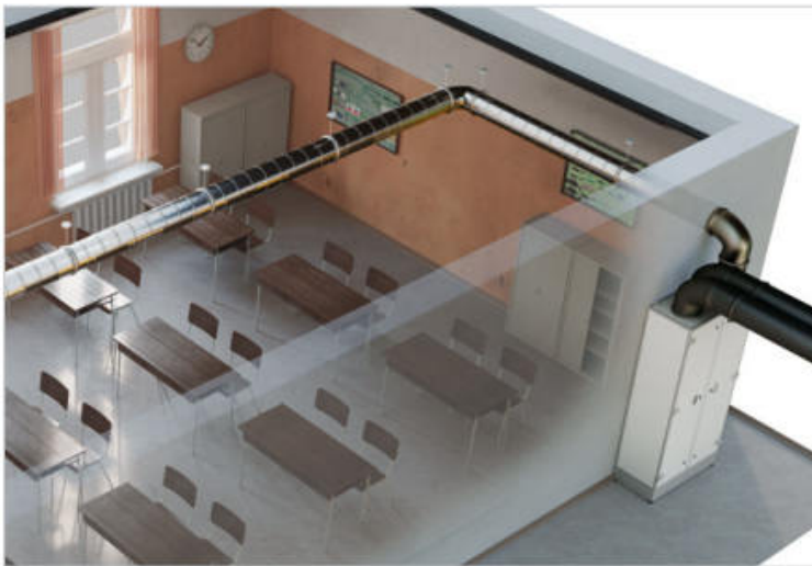
Aufstellung im Nebenraum mit Wanddurchbruch und Kanälen für Luftverteilung
