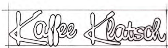
Skizze zur Ermittlung einer Gesamtfläche: Rechteck um Gesamtwerbeanlage aus Einzelbuchstaben
